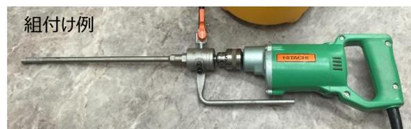
蓄圧式給水ポンプにミストドリルを接続し、コックにより水の調整を行い、ドリル先端から流水することを確認して削孔を行ってください。(削孔器具セット参照)
