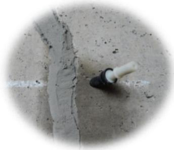
「ベヴェルプラグ」は、コンクリート構造物に発生したひび割れに微粒子セメント系材料を注入するための専用プラグです。材料をひび割れに直接、連続して注入することで、0.2mm～5.0mm程度までの幅広いひび割れに適用できます。Φ10.5mmの削孔穴にワンタッチで装着可能で、注入後に材料の逆流を防止する逆止弁機能を内蔵しています。
